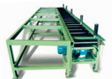
Alimentador con cuna almacén Feeder with storage cradle Alimenteuse avec berceau magasin
