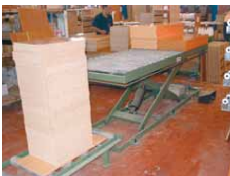
Encimera con tope posicionador abatible. Platform with folding positioner. Plate-forme avec butée de position abattable.
