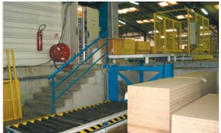
Plataforma de montaje con mesa elevadora. Assembly platform with lift table. Plate-forme de mon-tage avec table élévatrice.
